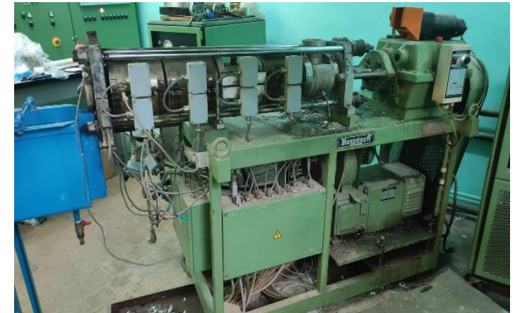
Экструдер для получения экспериментальных образцов (Институт Синтетических полимеров РАН)
