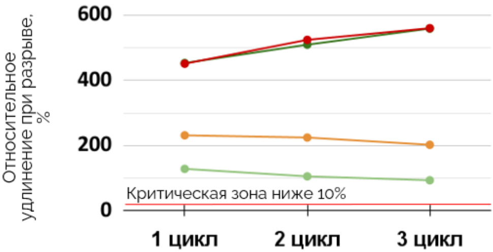
Зависимость относительного удлинения при разрыве от УЗ и цикла переработки
